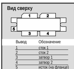
Кремниевый n-канальный транзистор с изолированным затвором, выполненный по LDMOS технологии
