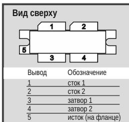
Кремниевый n-канальный балансный транзистор с изолированным затвором, выполненный по LDMOS технологии
